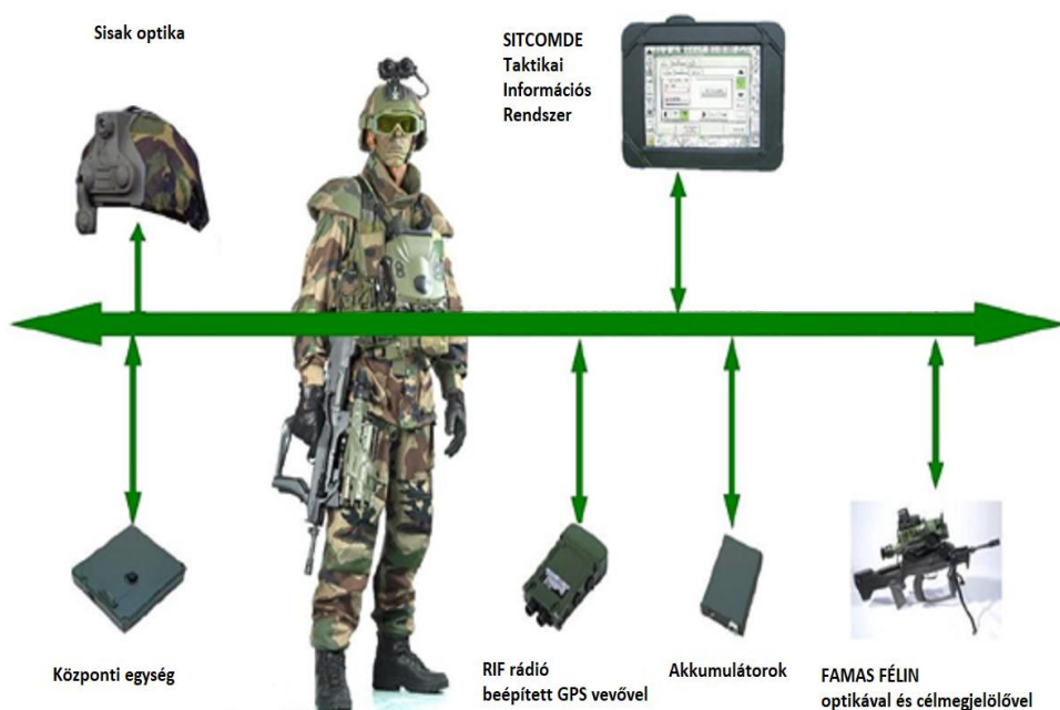
2. számú ábra. A FÉLIN-rendszer energiaellátó rendszere (forrás: 14 alapján készítette a szerző)
