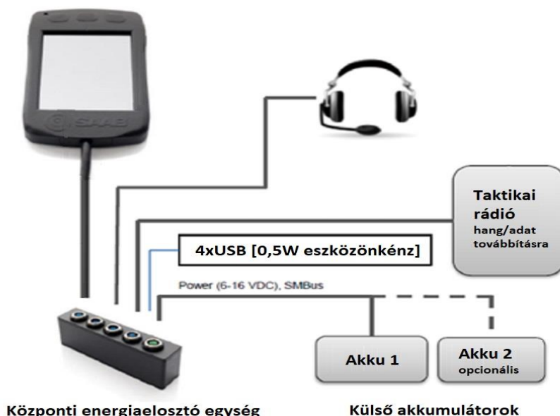
4. számú ábra. Az ISSP-rendszer energiaellátó rendszere (forrás: 31 alapján készítette a szerző)
