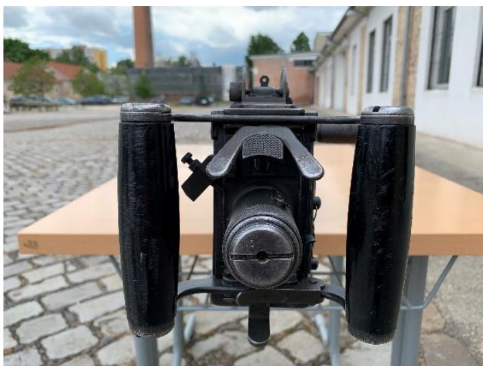
24. számú ábra. Szerelt hátlap az elsütőszervezettel (forrás: a szerző saját felvétele)
