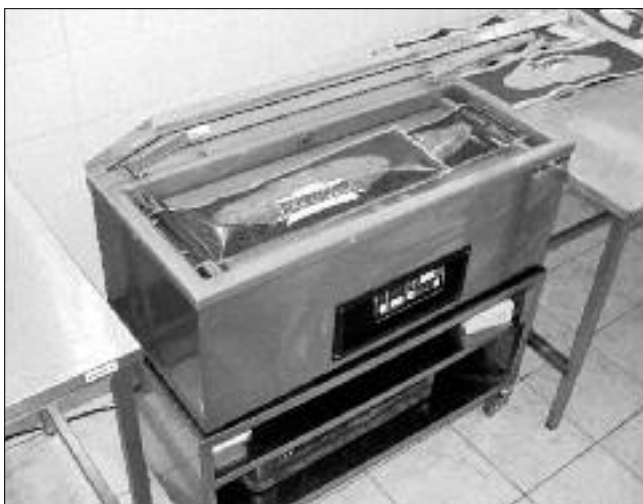
A hosszú kamrájú vákuumos csomagológépben az egész filék is könnyedén elhelyezhetők
