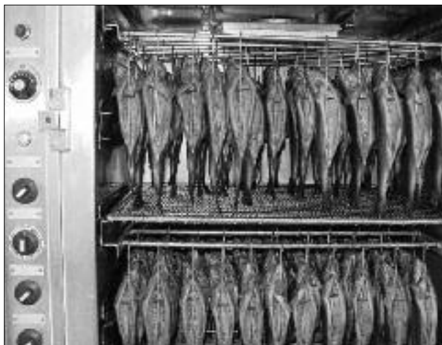
Az automata halfüstölőben 3 óra alatt egyöntetűen aransárgára füstölődik a 150–180 egész pisztráng
