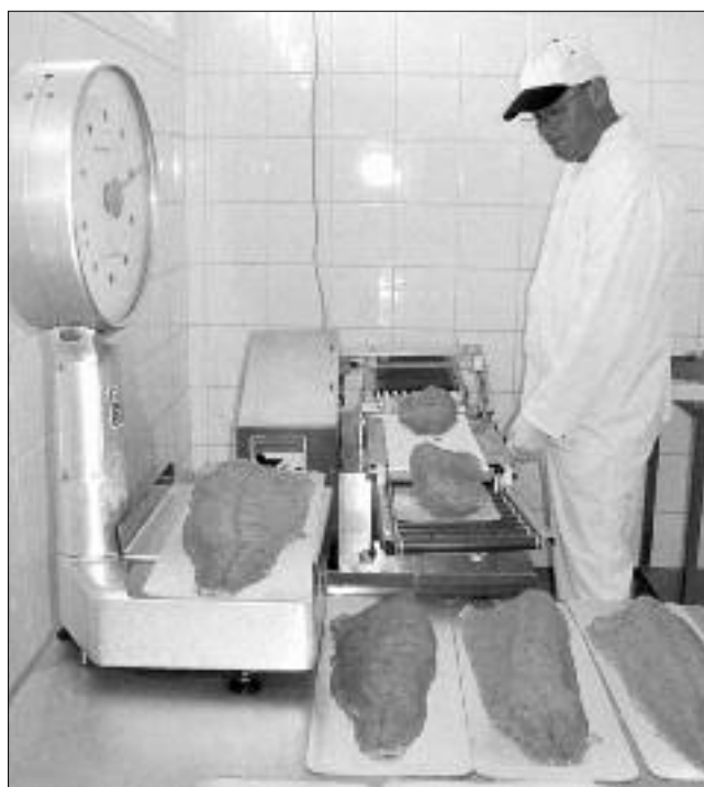
Az egyenletes szeletvastagságot a gépi szeleteléssel biztosítják
