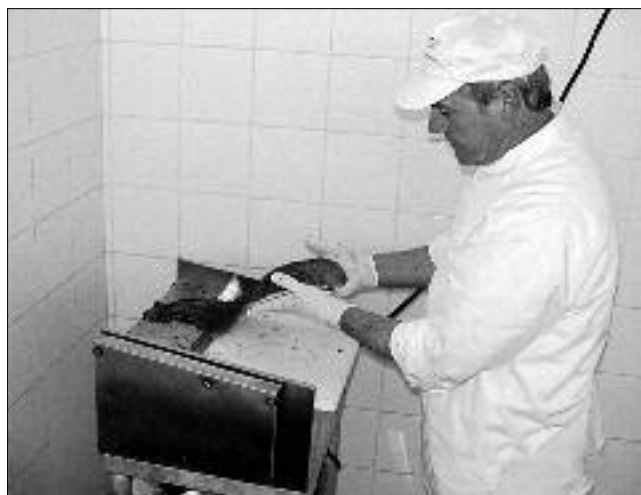
A lazacfilék füstölés utáni bőrözését géppel végzik
