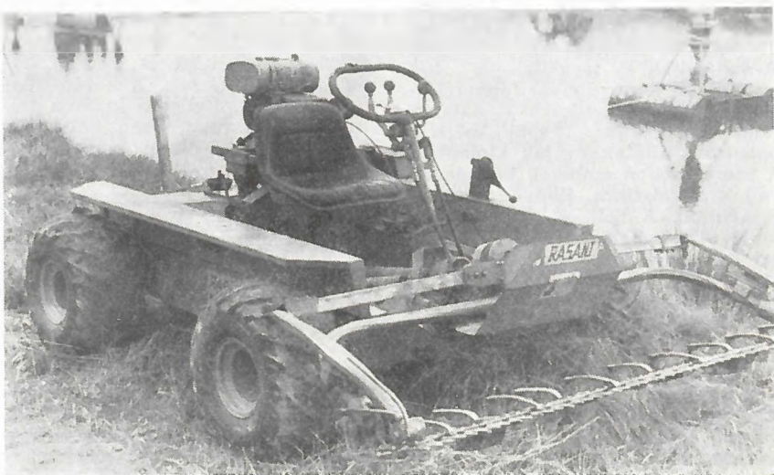
Osztrák fűkasza: a legmeredekebb töltésoldalon is használható
