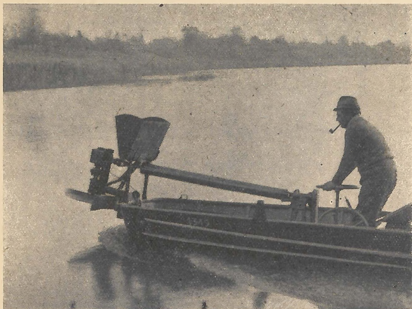
Műtrágyaszóró Esox üzem közben
