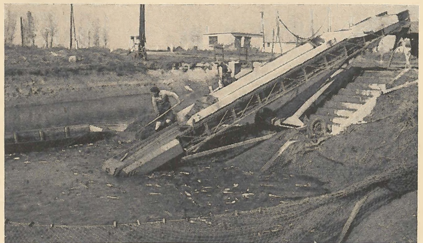
A központi halágyból végtelenített szalag viszi fel a halat a válogatóasztalra (Jakab felvételei)
