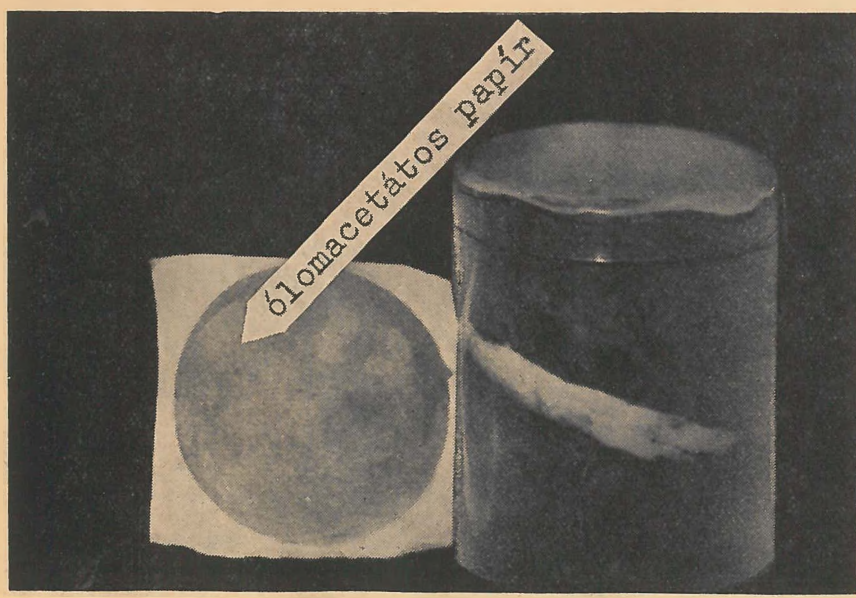
2. ábra. Az iszából távozó kénhidrogén ólomacetátos papírral kimutatható
