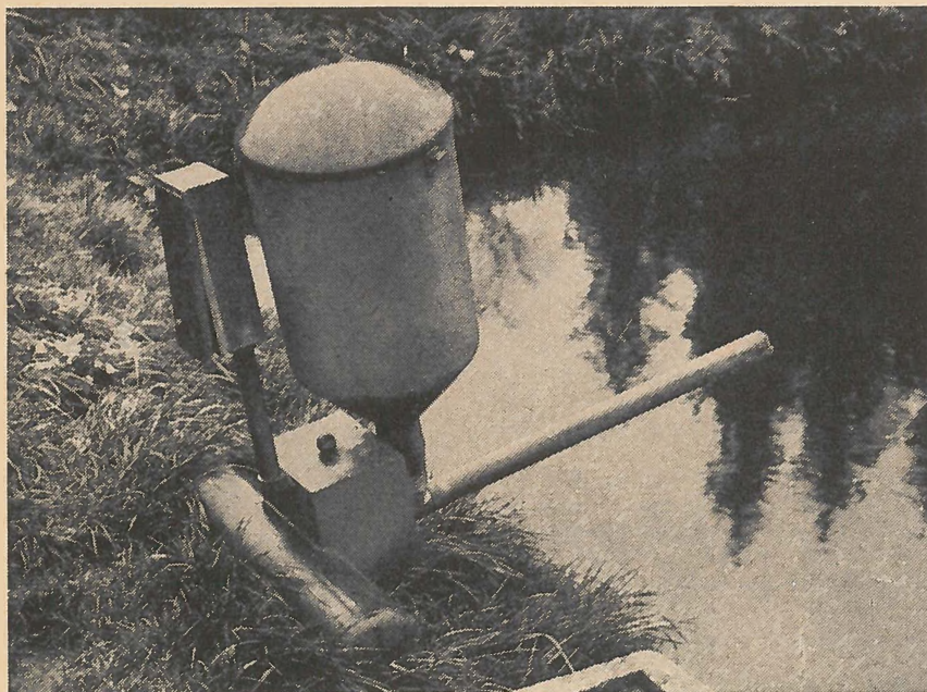
A „takarmányágyú” műanyag tartályból és belőle kivezető csőből áll. Központi elektromos vezérlésű, sűrített levegő lövi ki a takarmányt (Csehszlovákia, Pékh felv.)
