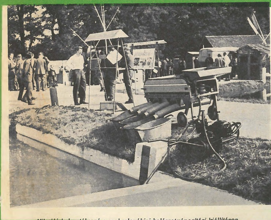
Vibráló halosztályozó a csehszlovákiai halászatgépesítési kiállításon. A gép teljesítménye óránként 4—15 q négy kategóriába válogatott hal
