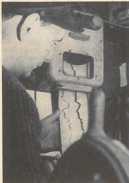
Az echográf nemcsak a tengerfenék mélységéről és domborzatáról, hanem a halpadok elhelyezkedéséről is hű képet ad
