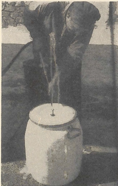
Hegesztőpisztollyal nyomjuk az oxigént a tartályba (Tölg felvétele)
