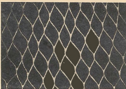
Egyszálú fonál hegesztésével készült a japán háló. A műanyag a hegesztési pontokon erősen meggyengül (az AFZ nyomán)
