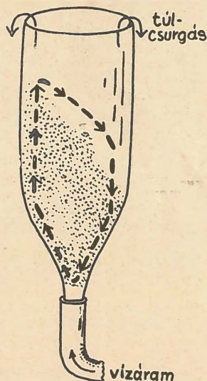
A vastag szaggatott vonal mutatja a Zuger edényben lefolyó ikráramlást. Az alulról feltörő víz egyik oldalon felfelé hajtja az ikrát, míg az a másik oldalon saját súlyától lefelé süllyed
