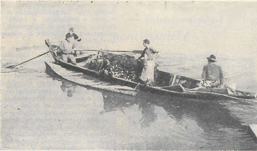
„Apatini“ halászladik. Az eredeti típus Apatinban épült és hosszú ideig csak ott készítették. Dunai halászok a legjobb halászladiknak tartották, és annak tartják néhányan ma is, noha már csak keveset lehet látni belőlük a magyar Dunán. Jellegzetessége, hogy orra is, fara is csúcsban végződik. (Woynárovich felv.)
