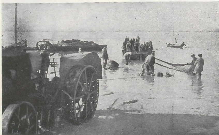
Halipari kombinát a Volgán. A hálók többszáz méter hosszúak, kézi erővel kihúzásuk lehetetlen, ezért erre a célra traktorokat használnak.
