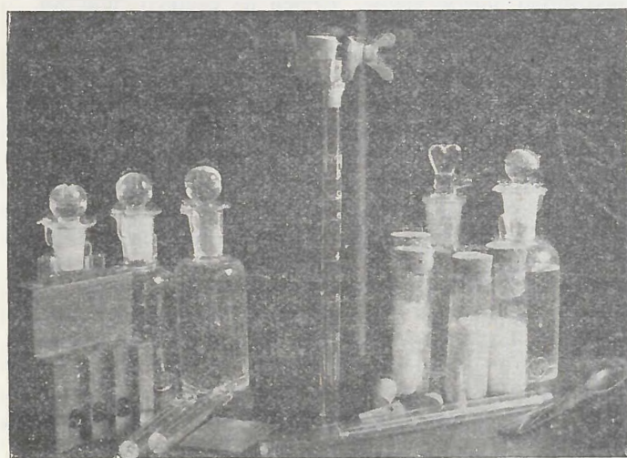
4. ábr. a mérőcső, a komparátor, továbbá az indikátorokat és reagenseket tartalmazó csepegtető üvegek és edények képe.
