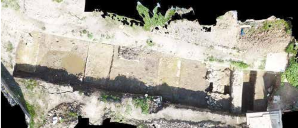
8. kép: A várakészakkeleti oldalán (18/5. szelvény) feltárt 14. századi hidpillérek és a kontrafal ortofotója
