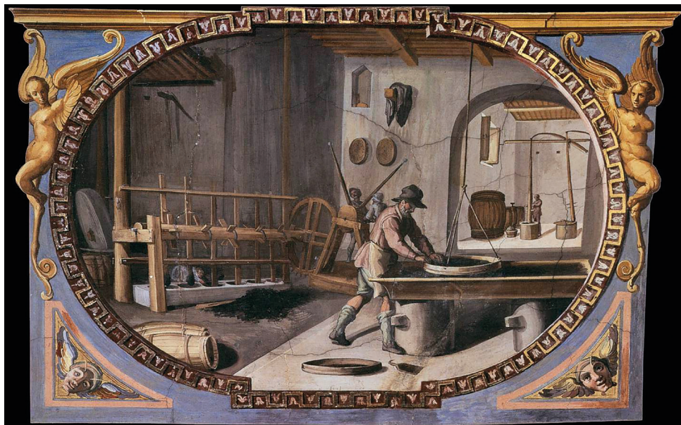
12. kép: 16. századi lőporkészítő üzem. Balra hátul az összetevők őrlésére szolgáló malomkerék, előtte kézi hajtású kalapácmű a keveréshez, a szemcsék egységesítéséhez. Az előtérben a mester szitálja a lőport. Jobbra hátul ellensúlyos kalapácmű látható (Lodovico Buti, 1558)
