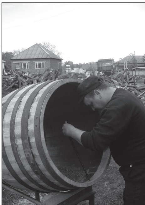
13. kép. A bodnár körzővel megméri a fenék területét, a csinbe beméri, kiszabja és legyalulja a fenékdongákat. A fenékdongák közeinek 1-1 szál gyékénnyel való tömítése után a tipliszéken kéthegyű kádárszeggel összeszegezik őket.
