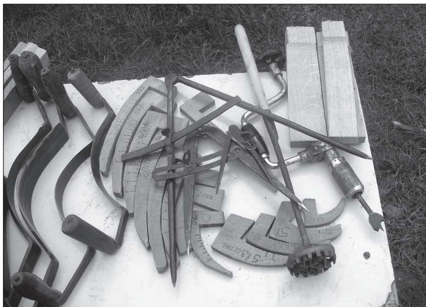
1. kép. Görbe vonókések, vaskörzők, furdancs és billogzóvas (A külön nem jelölt fotók a szerző 2015-ben készült felvételei)
