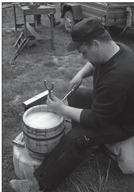
14. kép. A fenék behelyezésénél fenékkihúzó (auszcigli, rákfark) használnak. A hordókészítés utolsó fázisa az abroncsolás. A huzató abroncsok helyébe fel kell tenni az új, végleges vasakat.
