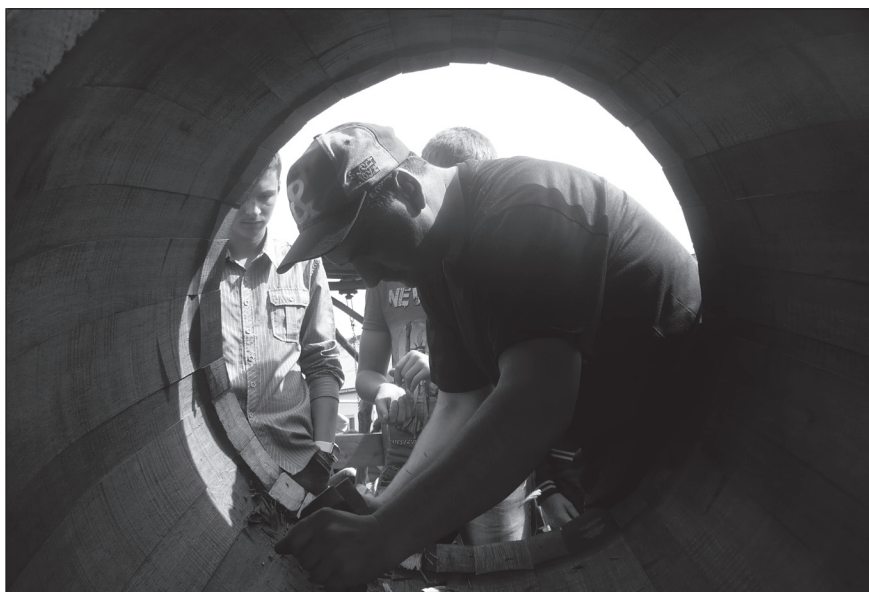
11. kép. A dongák megjelölt végeit körbefürészelik, görbekéssel, bütöző gyaluval simára dolgozzák. Majd a gárhóblival meggyalulják a csin tetejét.
