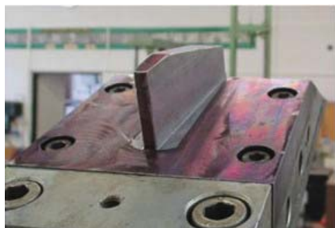
1. ábra Az áttervezett 5 mm-es szélességű ütőél a csökkentett tömegű kalapáccsal, a mérőbéli gégek nélkül
