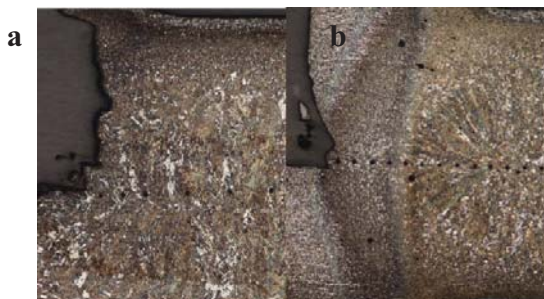
6. ábra Próbatestek törési helyeinek mikroszkópi csiszolatai a) folyamatos energiabevitelnél, b) szimmetrikus kétimpulzusú szakaszos energiabevitelnél
