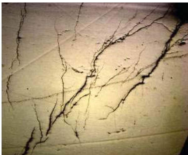
4. ábra Jellemző repedés polírozás után, 1-es mintavételezési hely (N=25x) [10]
