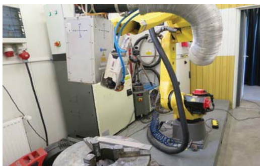
3. ábra A szórt réteg újraolvasztása FANUC robotra szerelt MWDL hőforrással
