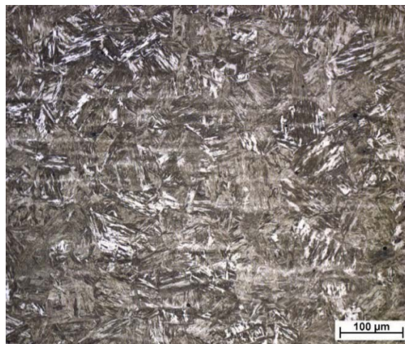
2. ábra Az alapanyag szövetszerkezete, N = 200x
