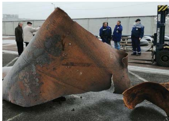
2. ábra Károsodott csődarab az FGSZ Földgázszállító Zrt. Miskolci Üzemében (In memoriam Dr. Nagy Gyula)
