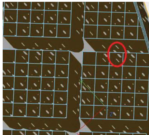
12. ábra: A „fragmentation” és piros körrel jelölt „gyémánt” kikönnnyítések
