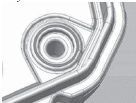
5. ábra: Módosított lekerekített PCB pozicionáló furat és alátámasztó sík
