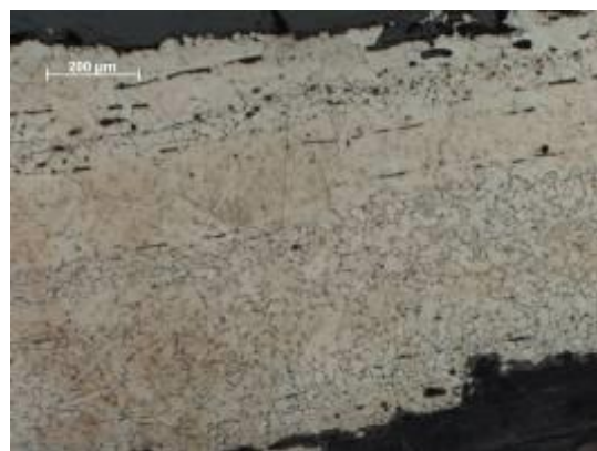
27. ábra. A fejsze élének réteges szerkezete.
