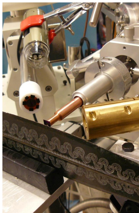
9. kép: A hajdúsámsoni presztízskard vizsgálata az Atomki nukleáris pásztázó mikroszkopjának kihozott nyalábos elrendezésével. A fókuszált ionnyaláb egy vékony \text{Si}_3\text{N}_4 fólián lép ki a levegőre. A keletkezett röntgen fotonokat két detektor (hagyományos \text{Si}(\text{Li}) és SDD) érzékeli a kilépő csővég két oldalán. Az SDD detektort egy mágnes védi a szórt protonoktól.
