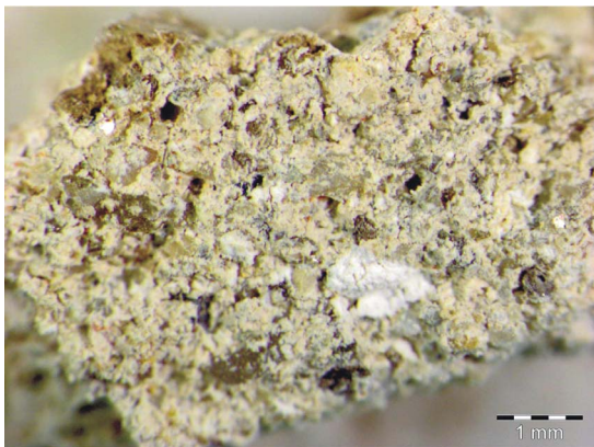
8. ábra. Mész kötőanyagú vakolat vagy habarcs darab, amiben osztályozott a homok adalékanyag. Barokk kori út feletti talajréteg. 25 x nagyítás
