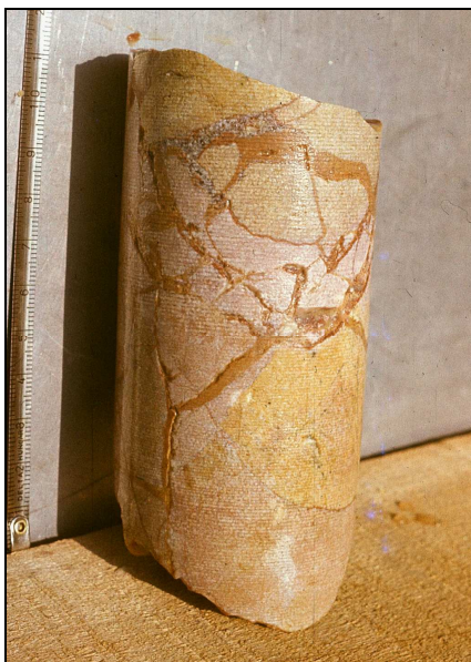
2. kép. Sárga színű metasomatikus (másodlagos) meszes dolomit a Vác-nagyszáli nóri mészkő fúrómagban.
