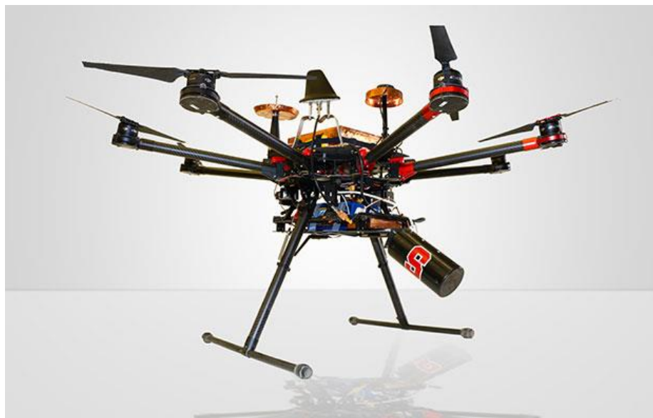
2. kép. GPS zavaró berendezést kereső oktokofter [6]
