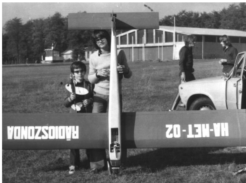
3. ábra A HA-MET-02 repülőmodell, hagyományos rádiószondával felszerelve, repülés előtt [6]
