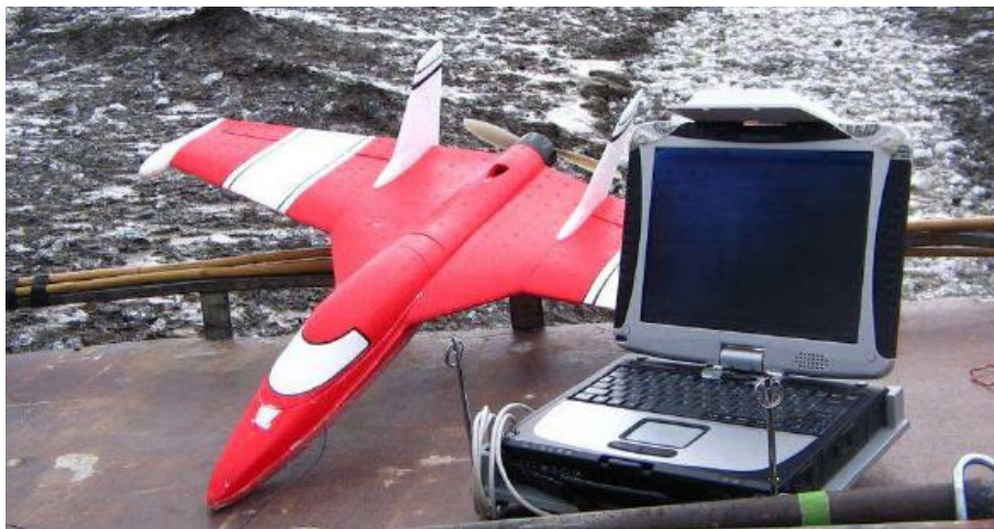
1. ábra A SUMO pilóta nélküli repülő időjárás megfigyelő eszköz légi és földi egysége [4]
