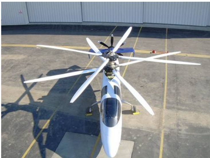
8. ábra. A Sikorsky X2 koaxiális elrendezésű forgószárnyai [3]
