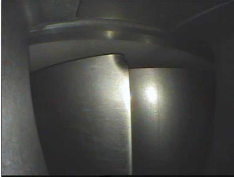
3. ábra endoszkóppal készült felvétel a turbinalapát sérüléséről
