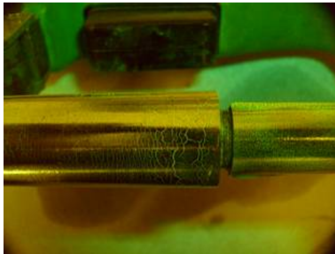
9. ábra etalon a mágneses roncsolásmentes anyagvizsgálat érzékenységének megállapításához
