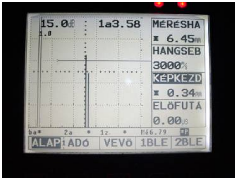
15. ábra. Az etalon hátfaláról visszavert visszhangjel
