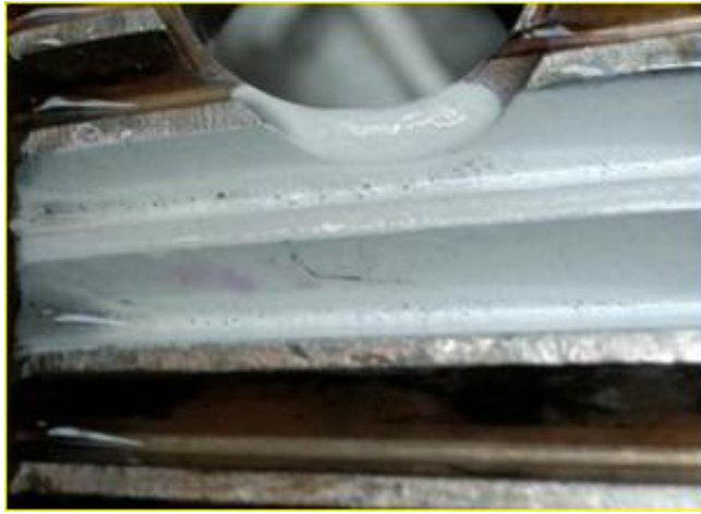
7. ábra fogaskoszorú mágneses roncsolásmentes anyagvizsgálata során detektált repedés
