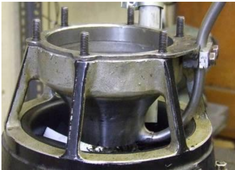
6. ábra. A fordulatszám-érzékelő elhelyezése az áramvonalazó kúpon belül
