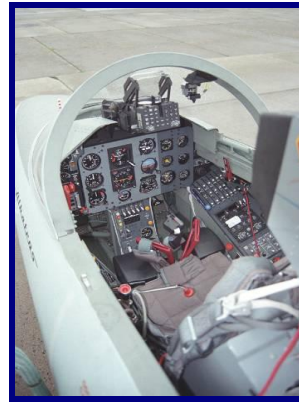
2-4. Az L-39 utolsó változata az L-39ZA/ART a Thaiföldi Királyi Légierő részére fel volt szerelve integrált digitális navigációs és fegyverzeti rendszerrel, beleértve a homloküveg kijelzőt (HUD), feladatspecifikus számítógépet és a gyűrűs lézergiroszkópra épülő inerciális navigációs rendszert.
