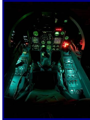
3-6. Az L-159 repülőgépezető fülke a HUD, az MFD és a HOTAS rendszerekre épül.
