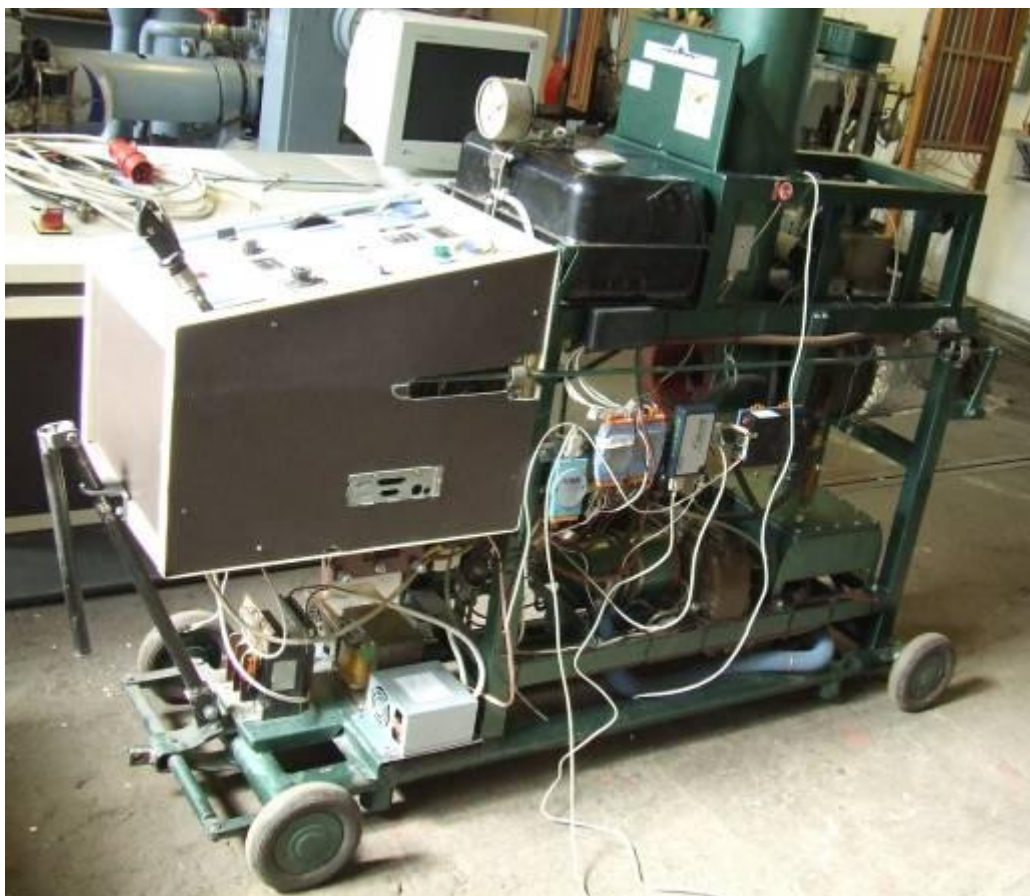
3. ábra. A gázturbinás sugárhajtóműves próbapad a Tanszék laborjában
