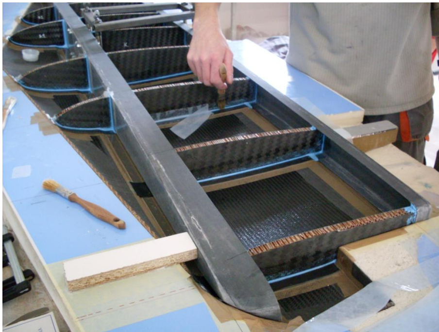
20. ábra – A vízszintes vezérsík gyártása a mart negatív forma sablonban
