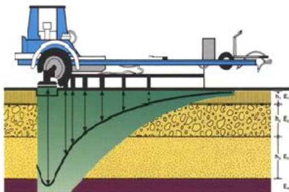
1. ábra. A behajlási teknő mérési elve.
