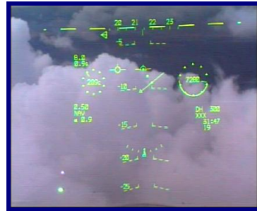
3-7. Az L-159 nagylátószögű HUD-al rendelkezik. Példa a HUD kijelzésre a jobboldali képen látható.
