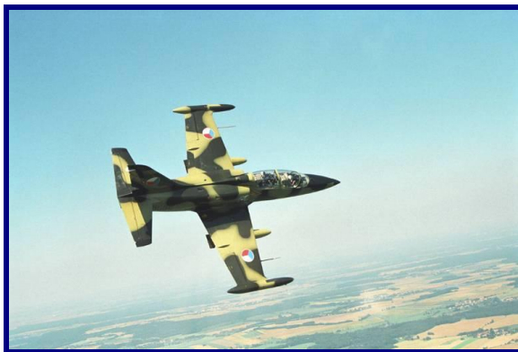
2-6. Az L-39MS repülőgépek kifejlesztése a korszerű Szovjet vadászgépekre való kiképzés érdekében történt. Nagyobb tolóerő-súly viszonytal és az L-39-nél nagyobb teljesítőképességgel rendelkeznek. Ezek a gépek fenti mellső elhelyezésű vezérlőpulttal rendelkező homloküveg kijelző, többfunkciós kijelző, rövid hatótávolságú rádió navigációs rendszer (RSzBN) és inerciális navigációs berendezés található.
