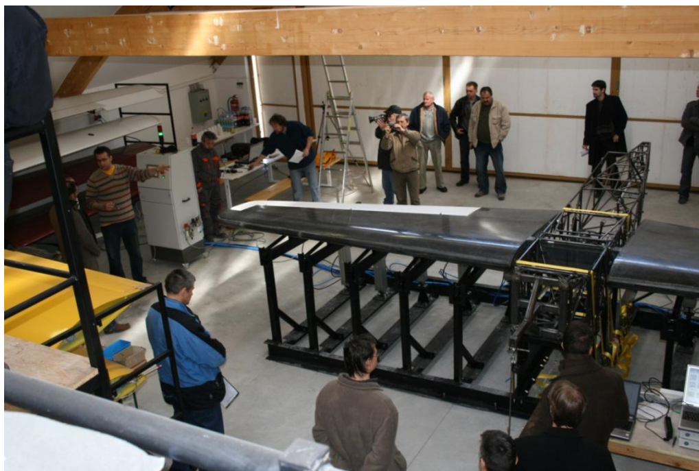
23. ábra – CORVUS RACER 540 szerkezete a szilárdsági bevizsgáláskor
