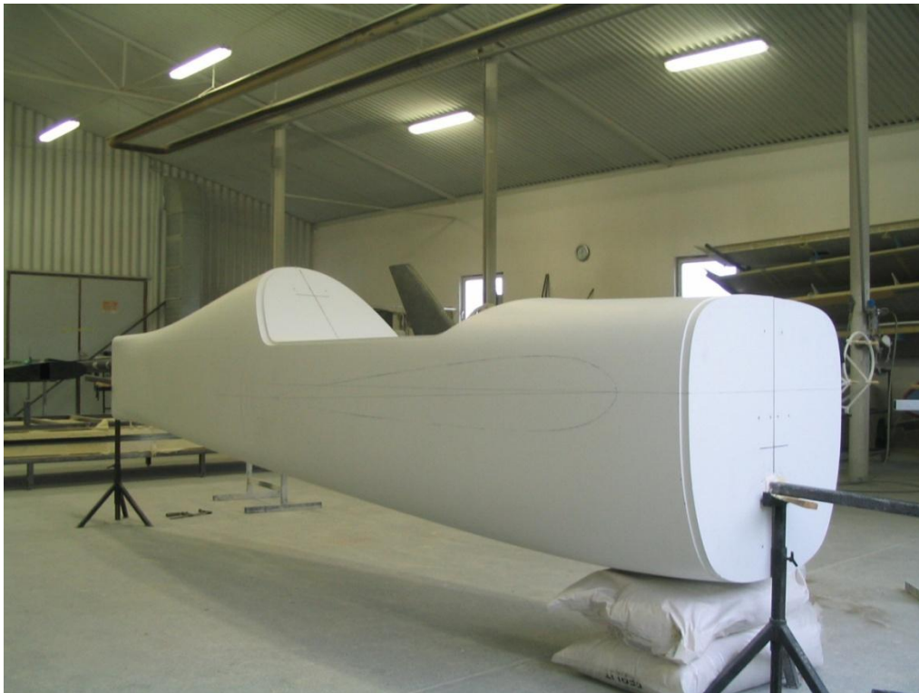
18. ábra – A két mart félből összeillesztett törzs pozitív ősminta a gyártócsarnokban
