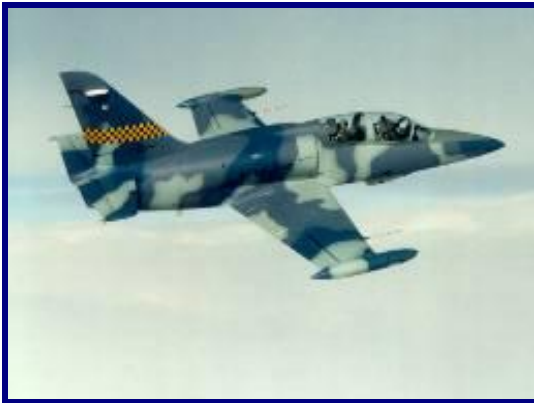
2-4. Az L-39 utolsó változata az L-39ZA/ART a Thaiföldi Királyi Légierő részére fel volt szerelve integrált digitális navigációs és fegyverzeti rendszerrel, beleértve a homloküveg kijelzőt (HUD), feladatspecifikus számítógépet és a gyűrűs lézergiroszkópra épülő inerciális navigációs rendszert.
