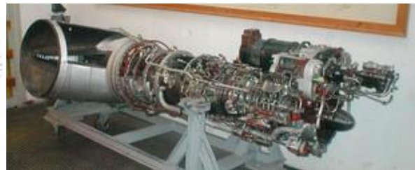
3. ábra. Az Izotov TV2-117A hajtómű volt az első orosz helikopterbe tervezett hajtómű
