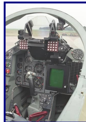
2-6. Az L-39MS repülőgépek kifejlesztése a korszerű Szovjet vadászgépekre való kiképzés érdekében történt. Nagyobb tolóerő-súly viszonytal és az L-39-nél nagyobb teljesítőképességgel rendelkeznek. Ezek a gépek fenti mellső elhelyezésű vezérlőpulttal rendelkező homloküveg kijelző, többfunkciós kijelző, rövid hatótávolságú rádió navigációs rendszer (RSzBN) és inerciális navigációs berendezés található.
