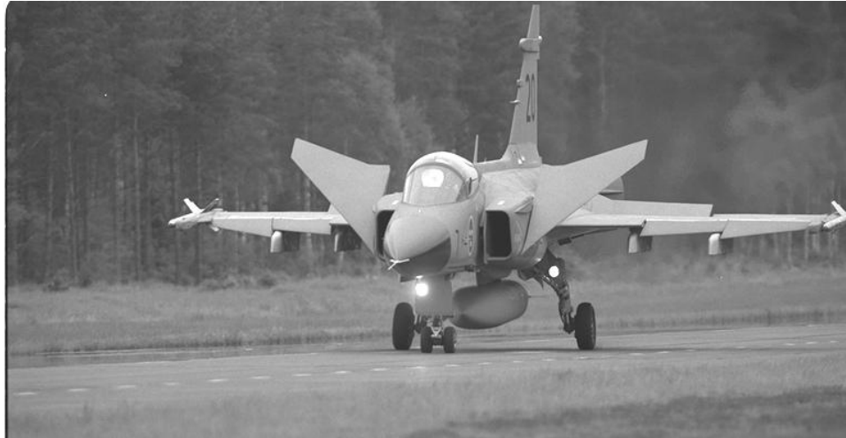
6. ábra. A GRIPEN sajátos fékezése
