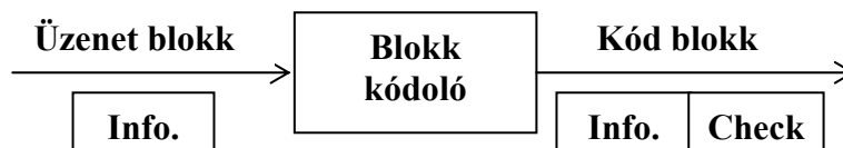
6. ábra. A blokk-kódolás
