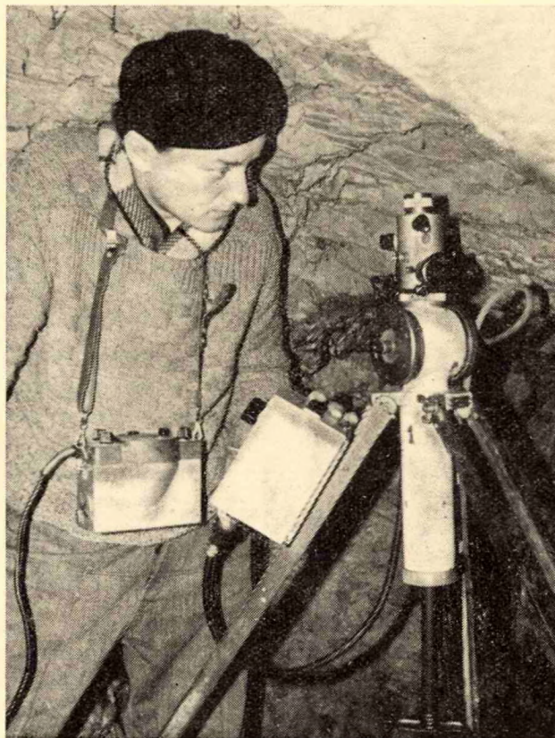
Fig. 7. Use of the Emanometer in the cave of Abaliget. 7. ábra Emanométeres mérés az Abaligeti barlangban.
