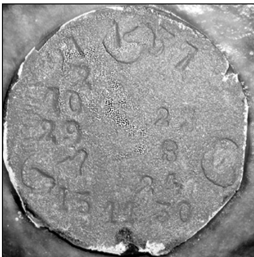
A kazán nyomáspróbáját tanúsító évszámok egy kis rézkorongba ütve.
