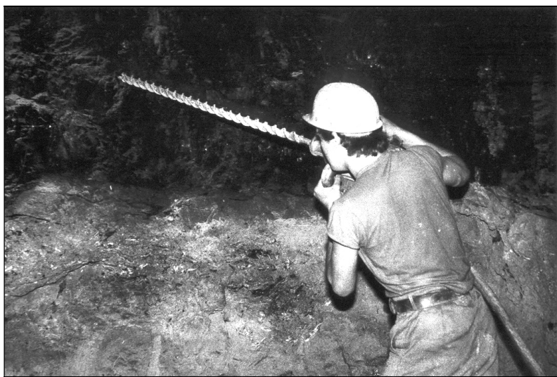
Robbantólyuk fúrása az egyik borsodi szénbányában, 1970-es évek.
