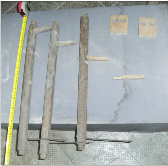
3. ábra Csúszkahúzó tengelyek karokkal, regiszterhúzó pálcákkal, tengelyágyakkal
