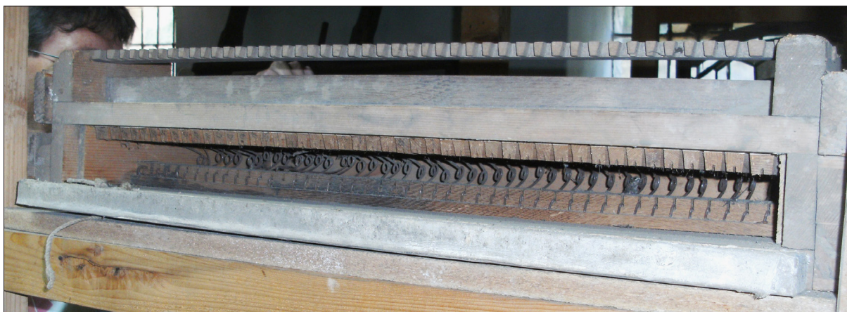
2. ábra A szelláda szelepszekrénye
