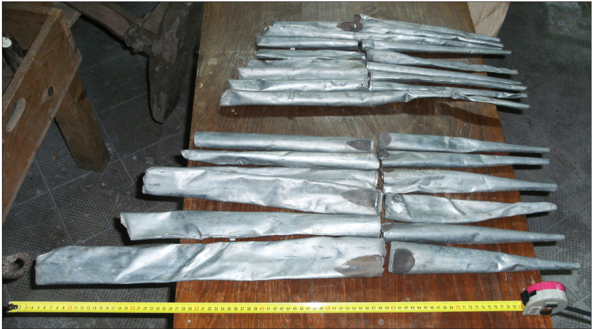
10. ábra A homlokzati fémcsipők (principál 2')
