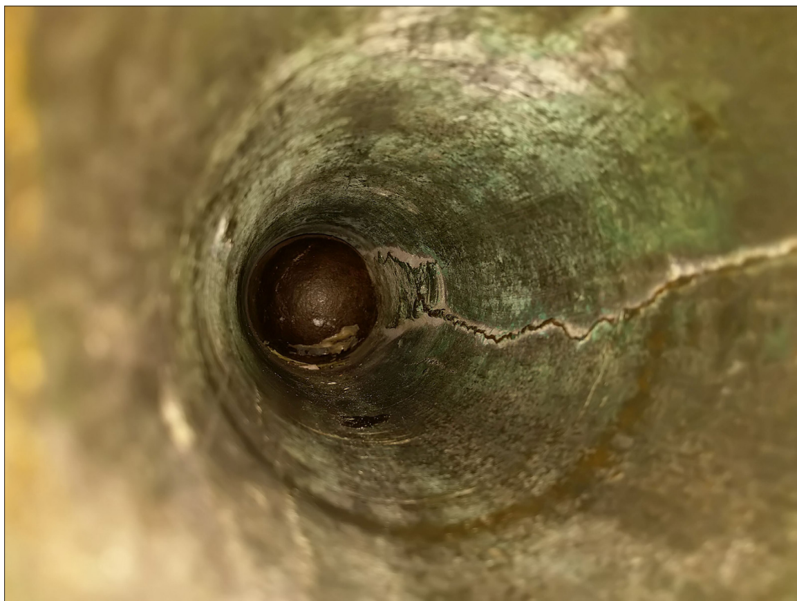
5. ábra A csőfuratban lévő hiba, mögötte egy beszorult ágyúgolyó
