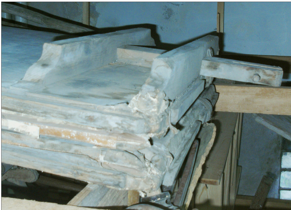
12. ábra Az egyik fűvó mozgó vége a merevítővel és a nyomórúd csatlakozásával
