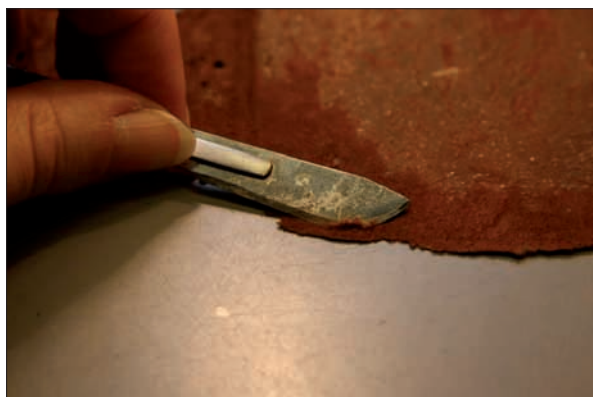
102. ábra Az eredeti kötésbőr széleinek elvékonyítása
