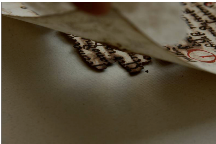
50. ábra A tintamarás szinte „égésnyomokat” okozott a papíron
