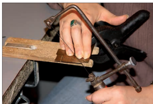
96. ábra A csat körvonalainak kifűrészése a lemezből
