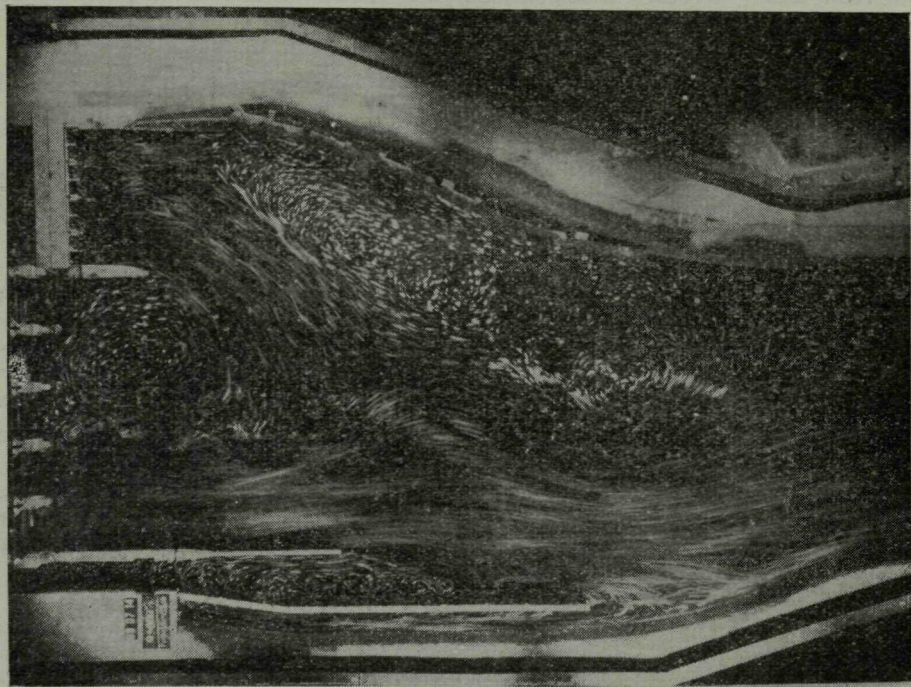
9. ábra. A duzzasztómű alatt kialakuló áramlási viszonyok, ha az erőtelep dolgozik, és a felesleges vizet a hajózsili mellett engedik le.
