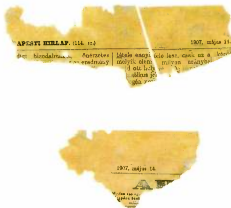
12. kép. Fsz. 5-ös sz. helyiség. A kétrétegű papírtapéta alá a vakolat repedezése ellen újságpapír megerősítést alkalmaztak. Budapesti Hírlap (114. sz.) 1907. május 14.
