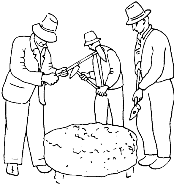
2. kép A malomkő faragása és egyenlítése. KÓS Károly 1980. 298.
