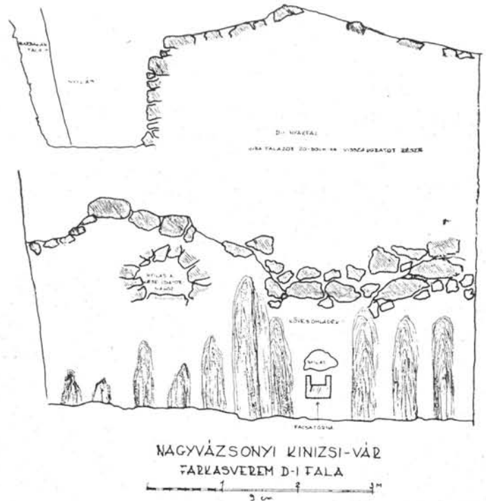
319. kép. A farkasverem D-I zárófala, vízáteresztő nyílásokkal Abb. 319. Südliche Schlusswand der Wolfsgrube, mit Durchlassöffnungen für das Wasser
