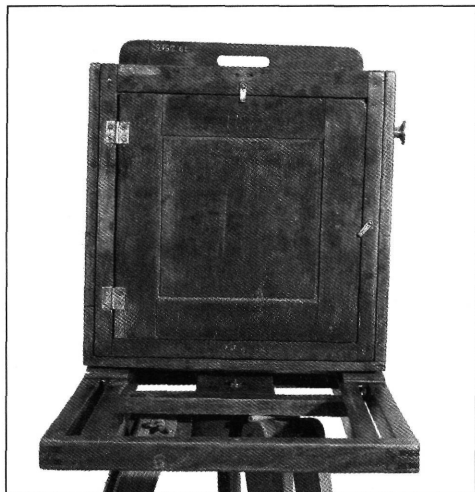
8. kép. A gép hátlapja a becsukott ajtájú kazettatartóval
