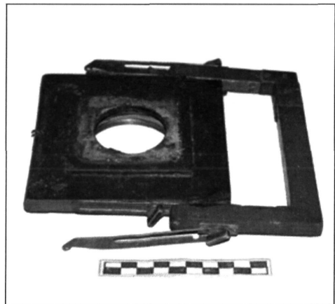
20. kép. Az előlap hátoldala a javításokkal és a farostlemezről leszakadt harmonika helyével
