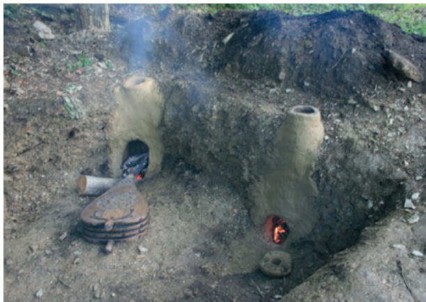
5. ábra. Kohók szikkasztása (kísérleti buca vaskohászat, Ómassa, 2010)
