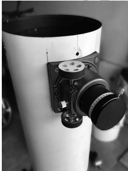
A fókuszírozó egy egyszerű Crayford-kihuzat
