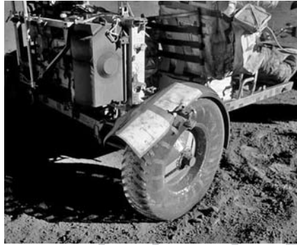
Az Apollo-17 holdautójának jobb hátsó sárvédője megsérült, a letört darabot pedig az űrhajósok egy holdtérképpel pótolták, amelyet duct tape-pel erősítettek fel (NASA)
