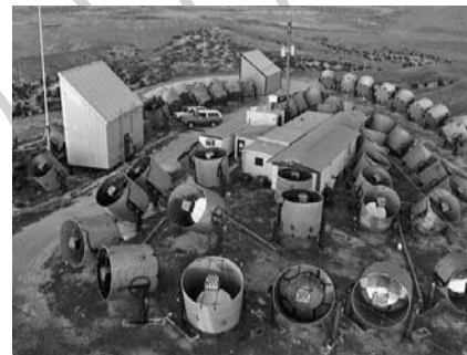
A nagyenergiájú kozmikus részecskék által a földi légkörben keltett kaskád-részecskék detektálására épített Fly's Eye (Légyszem) műszeregyüttes, amellyel az „Uramisten!” részecskét is elcsípték (alchetron.com – Free Social Encyclopedia for the World)
