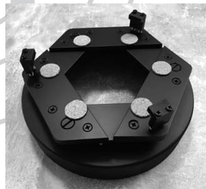
A főtükörtartó, már festés után. Hat darab parafakorong került felragasztásra, erre fekszik majd fel a tükrő. A danamitból kifűrészelt, kireszelt leszorító körmök is a helyükre kerültek
