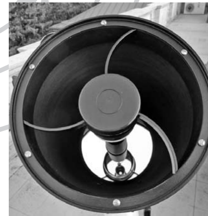
A TAL Klevcov-Cassegrain-távcső segédoptikájának görbült segédoptika-tartó lábai (a szerző felvétele)
