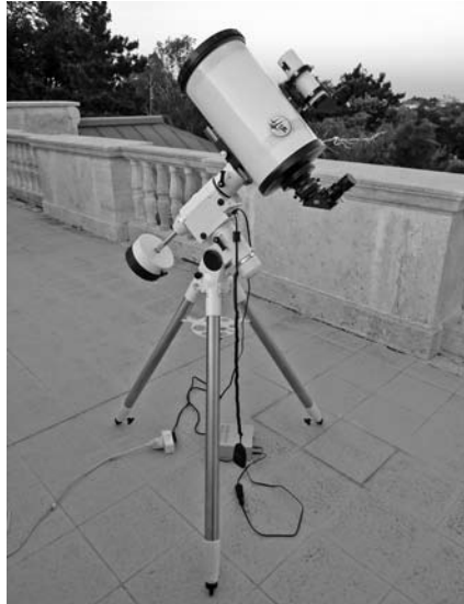
Egy TAL200K 200/2000 mm-es (f/10) Klevcov-Cassegrain-távcső HEQ5 állványon 220V/12V AC/DC stabilizált átalakítóval. A kereső egy TS 9x50 mm-es keresőtávcső Amici-prizmával (a szerző felvétele 2019. június 8-án készült Budapest-Svábhegyen).
