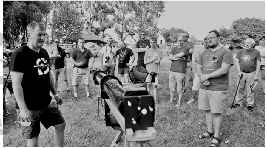
Schlosser Sándor saját építésű 15 cm-es Kutter- távcsöve. Ezen a tubuson sincs bonyolultabb szerzőmaggéppel készült alkatrészt, az építője egyéni ötletekkel pótolta azokat, illetve fellelt alkatrészeket használt fel célszerű átalakítás után (csillagnezok.hu)
