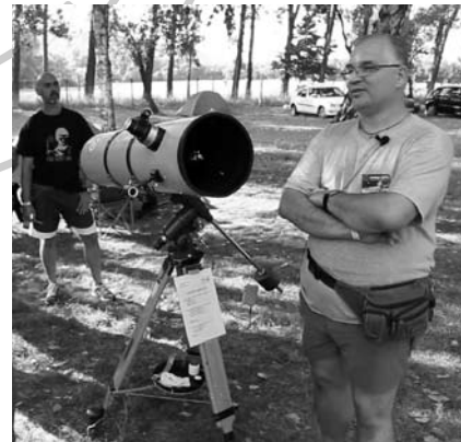
Rékasi Gergő bemutatja 200/1030-as Newton-távcsövet az MTT 2019 alkalmával. A tubus panellakásban készült, és kizárólag egyszerű szerzőmaggé álltak hozzá rendelkezésre. Anyaga impregnált karton, de ez közvetlen közelről sem tűnik fel azonnal, mert nagyon ügyes kidolgozás! A karton súlya kicsi, nagyon tartós és szilárd, megmunkálása pedig könnyű (csillagnezok.hu)
