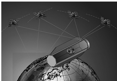
6. ábra • A GOCE űrgradiométeres műhold, melynek pályáját a GPS-műholdak segítségével határozzák meg nagy pontossággal. (Forrás: GOCE Projektbüro, München)
