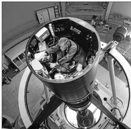
Az ESO 3,6 m-es teleszkópja a felavatás előtt – ma már történelem a primer fókuszba helyezett észlelőfülke
