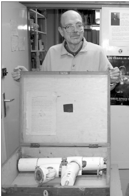
Büszkén mutatja Hudoba György Székesfehérváron ezt a 72/500-as refraktort, mely a hatvanas évek elején sorozatban készült. A kítűző MOM-objektívhez Orgoványi János tervezte a mechanikát. Ilyen távcsővel kezdte meg a városban a bemutatókat Hajmási József
