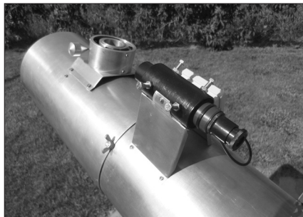
A kereső tartóját teljesen magam készítettem, megjelenésében a tubushoz illő formában
