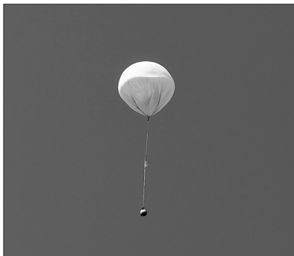
Ezen a felvételen jól látható a kutatóballon szerkezete, felülről lefelé: maga a ballon, alatta a csukott állapotban lévő ejtőernyő, legalul pedig a kutatóballon. A kép a felbocsátást követő percekben készült Hegyhátsálról (Fotó: Hegedűs Tibor)
