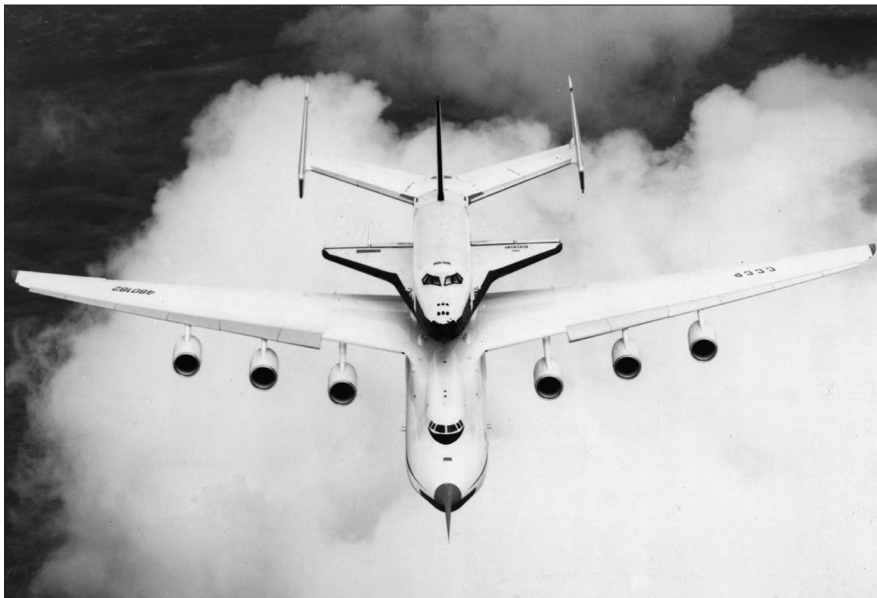
A Burán a szállítására kifejlesztett Antonov-225-ös (Mrija) hátán. Ez a jelenleg is üzemelő legnagyobb szállítórepülőgép, teherbírása 250 tonna
