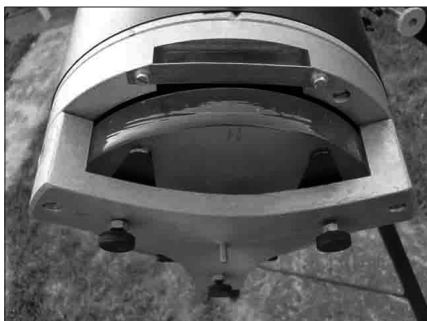
A tükrőfoglat teljesen öntött alumínium, a felső részén látható kimart fészekbe radiális ventilátor csúsztható melyet egy rézlemez rugt. A légáram végigsöpri az optika felületét, a lefűjt levegő a foglat tülso oldalán kimart csatornákon át távozik
