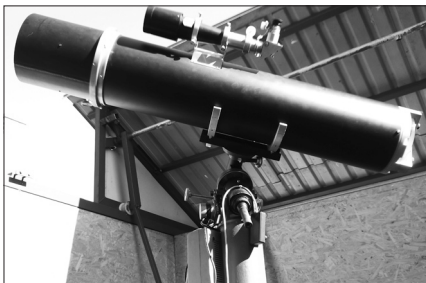
Saját készítésű, 195/1300-as Newtonom, melyet bolygóészlelésre optimalizáltam
