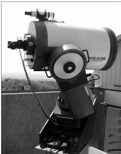
Az obszervatórium főműszere, a 40,6 cm-es Meade LX200 GPS Schmidt–Cassegrain-távcső
