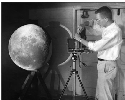
Bill Hartmann éppen a Holdat fényképezi. A technika nagyon szellemes és meglepően egyszerű. Hartmann egy közel egy méter átmérőjű gömbfelületre vetítette ki a Hold fényképét, majd ezt fényképezte le újra, de más és más irányból
